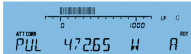
**Anzeige des Modulationsgrades eines amplitudenmodulierten Signals**
